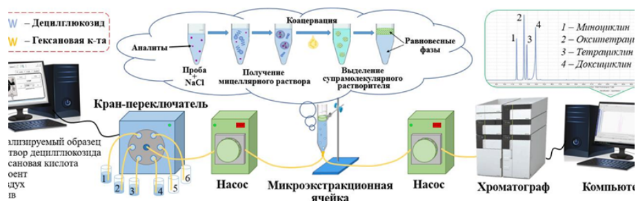
Рис. Гидравлическая схема для автоматизированного определения тетрациклинов в слюне после микроэкстракции в супрамолекулярный растворитель на основе алкилполиглюкозида.
