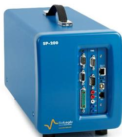
SP-200 - современный модульный потенциостат /гальваностат/FRA (анализатор частотного отклика) исследовательского класса с отличными возможностями. Одноканальный прибор, обладающий всеми техническими характеристиками старших моделей линейки. Обеспечивает доступ к контролю эксперимента по локальной сети и несколькими пользователями. Может работать с внешним усилителем тока HCV-3048 (30 А, 48В). Минимальный диапазон тока – 1 пА, EIS до 7 МГц, генератор линейной развертки до 1 МВ/с.
